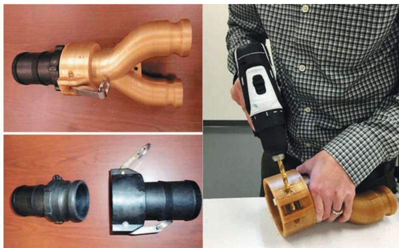
Рис. 7. ULTEM в ремонтном производстве: модернизированный патрубков из ULTEM в сборе; старая конструкция патрубков; легкость обработки деталей из ULTEM
