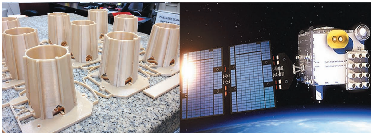
Рис. 12. Опоры антенных решеток для метеорологических, ионосферных и климатических спутниковых систем космических наблюдений, изготовленные по технологии FDM
