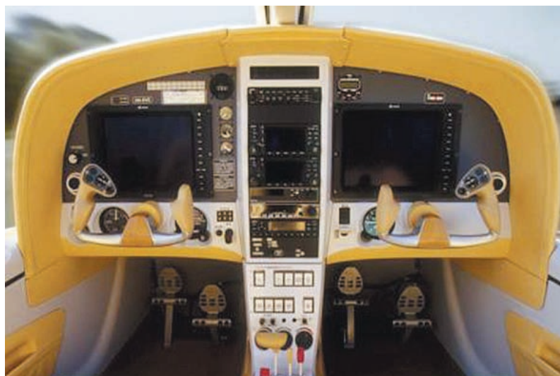
Рис. 8. Детали интерьера частного самолета VUT100 Cobra чешской компании Evektor «напечатаны» из ULTEM 9085
